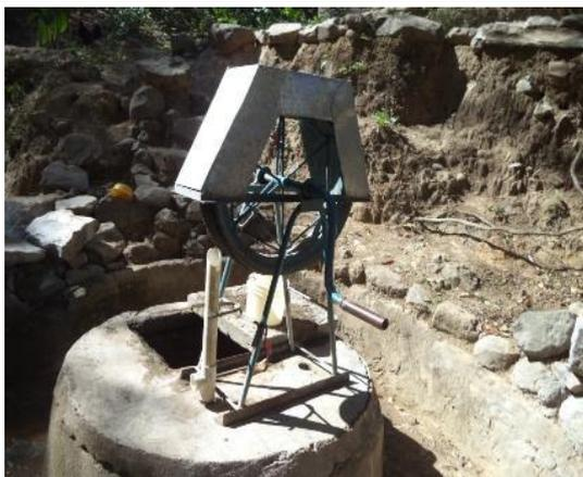
Pozo excavado com bomba de mecate (Nicaragua)
